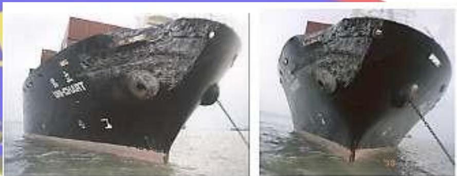
Gambar 21. Tempat luar kerusakan MV Uni Chart. Kuku jangkar kanan hilang.
