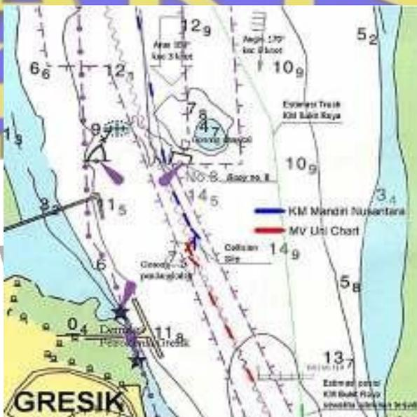
Gambar 13. Detail lokasi tabrakan antara MV Uni Chart dengan KM Mandiri Nusantara pada saat terjadinya yang terjadi di sekitar Bay no 5 dan Damage Petrokimia.
